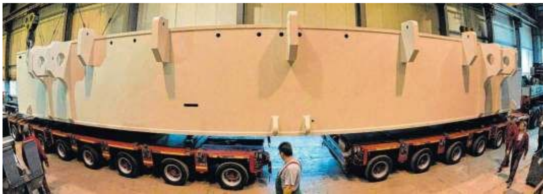
Das Chassis für eine Biegepresse entstand bei der Anlagentechnik Aschersleben und wird per Schwerlasttransport zu Schiess auf der anderen Straßenseite transportiert.
